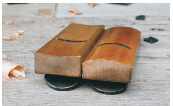
側面を削る丸鉋。直径にあわせてサイズもさまざま。
